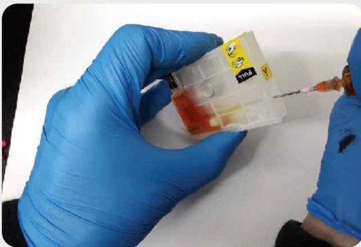
Por el orificio frontal del cartucho cargar con tinta utilizando la jeringa con aguja provista en el kit.
