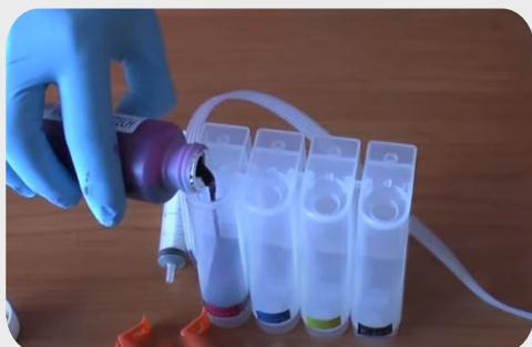
Llene cada recipiente de tinta con el color correspondiente. Una vez colocadas las tapas, destape todas las entradas de aire.
