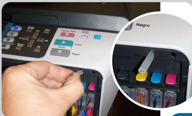
Inserte la goma de silicona en la ranura como muestra la figura. Esto anula el sensor de la tapa de la impresora.
