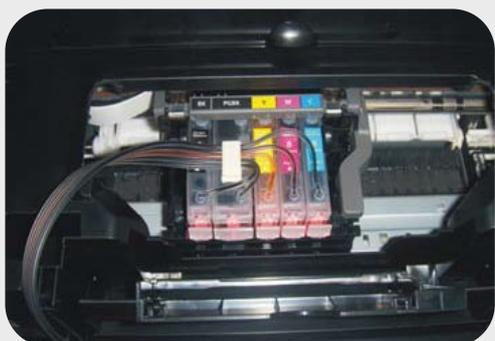
Encienda la impresora. Espere que el carro se posicione en el medio. Coloque los cartuchos en la impresora. Verifique que todos los cartuchos estén en la posición correcta y que estén alineados. Desenchufe la impresora de la corriente.
