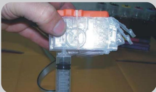
Retire los taponcitos de todos los cartuchos. Inserte la jeringa en el agujero que queda destapado de uno de los cartuchos (como muestra la figura) y succione el aire hasta que el cartucho se haya llenado (cuando realiza este proceso siempre mantenga al revés los cartuchos). Realice el proceso con todos los colores.
