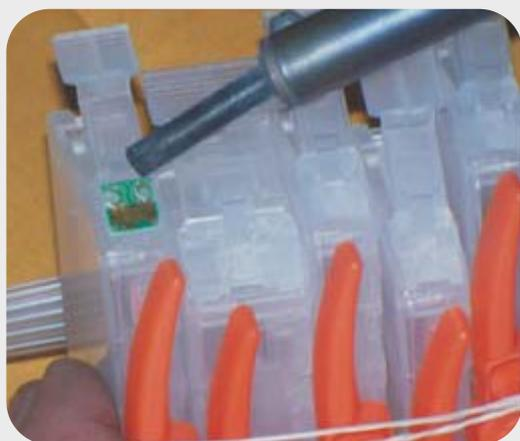
Retire los chip de los cartuchos originales. Estos están soldados con dos puntos de soldadura de plástico que se ven a simple vista. Con un cutter corte estos puntos de soldadura para poder retirar el chip. Tenga cuidado que no se mezclen los colores. Cada chip corresponde a un color, por más que sean iguales a simple vista.
