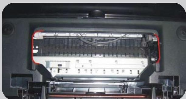
Realice un corte en la impresora como muestra la figura para permitir el paso de los cartuchos y mangueras del sistema.
