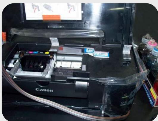
Enchufe la impresora. Levante la tapa y espere que el carro se posicione en el lugar de cambio de cartuchos. Fíjese que el cabezal de la impresora esté colocado. Coloque las trabas para sostén de manguera como indica la figura.
