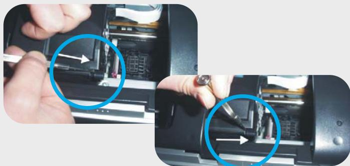
Con la impresora desenchufada, saque la traba derecha de la tapa de los cartuchos, para esto utilice un destornillador de punta chata, empujándola hacia la derecha.
