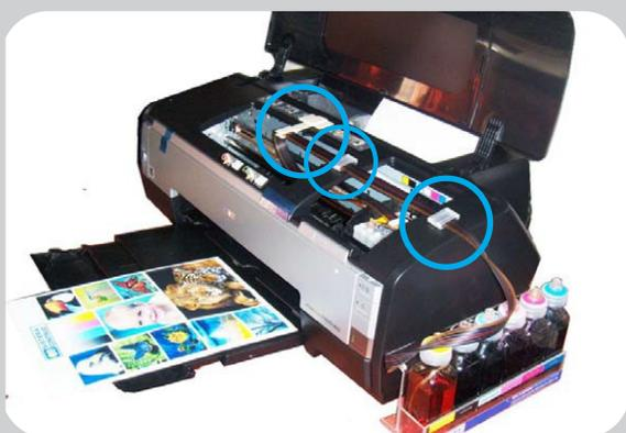
Coloque la manguera dentro de los soportes. Con la mano lleve el carro hacia la derecha. Luego lleve el carro hacia la izquierda controlando que la manguera haga el recorrido y no quede tirante o muy larga.
