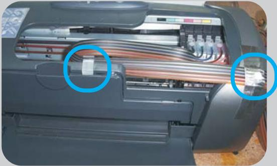
Coloque los soportes con forma de “LIBRO” que se incluyen en el sistema como se muestran en la imagen.
