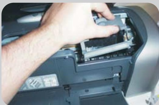
Inserte los cartuchos del sistema continuo previamente cargados en la impresora.
