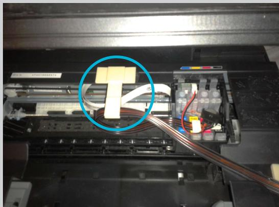
Coloque la manguera en el soporte "T" que instaló anteriormente.
