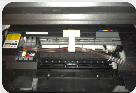
Corra el carro de un lado hacia el otro para cuidando que no se trabe. Esto es para verificar que el carro pueda moverse con libertad al imprimir.
