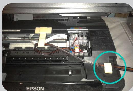
Coloque la manguera en el segundo soporte como se muestra en la imagen.
