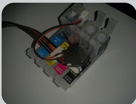
Coloque la pila al sistema, preste mucha atención en la polaridad de la misma.
