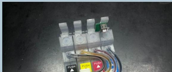
**IMPORTANTE: USTED DEBE RESETEAR EL CHIP DE LOS CARTUCHOS EN EL MOMENTO QUE EL INDICADOR CON FORMA DE GOTA QUEDA PRENDIDO EN FIJO.**
