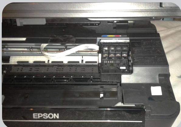
Encienda la impresora y abra el escáner. El carro de los cartuchos se pondrá en la posición de cambio.
