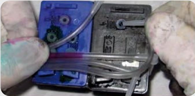
Conecte las mangueras insertando las L en cada uno de los bujes que instaló en el paso anterior.
