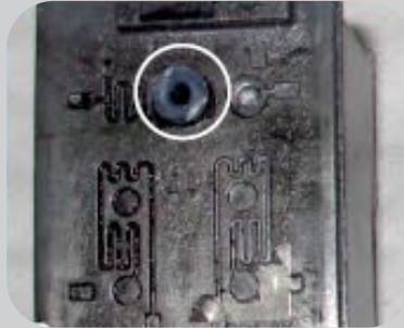
Inserte los bujes en los orificios libres como se muestra en la imagen.
