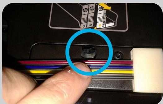
Anule el sensor de la tapa de la impresora, tapando el orificio del mismo como se muestra en la imagen.
