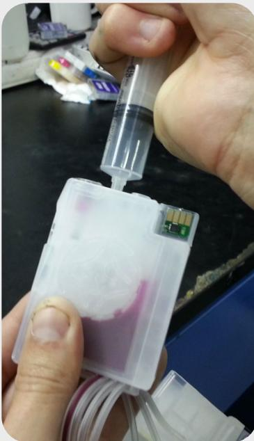
Notará en la imagen como se realiza el purgado. Recuerde tener las entradas de aire de las botellas de tinta abiertas.
