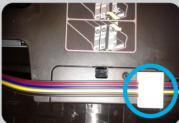
Luego coloque el otro soporte LIBRO y proceda a colocar las mangueras en ambos soportes colocados.
