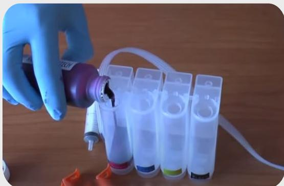
Llene cada recipiente de tinta con el color correspondiente. Una vez colocadas las tapas, destape todas las entradas de aire.
