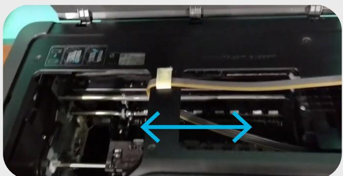
Corra el carro con la mano de un lado hacia el otro cuidando que la manguera no esté muy corta o muy tirante. Esto es para verificar que el carro pueda moverse con libertad al imprimir.
