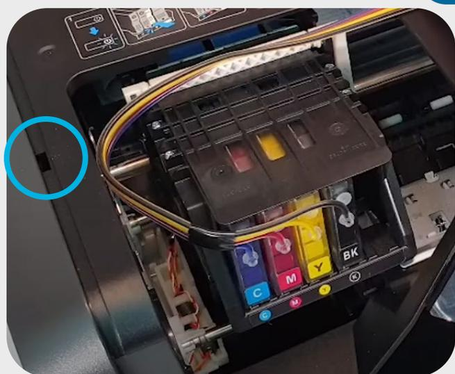
Coloque el tapón que se incluye en el instructivo en el sensor de la tapa. Una vez realizado el paso anterior su impresora está lista para imprimir con Sistema continuo.
