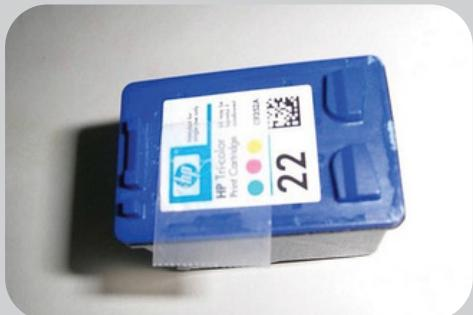
Limpiar la entrada a los tres orificios y devolver la etiqueta a su sitio para impedir la entrada de aire a los depósitos.
