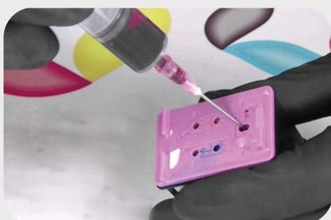
La recarga se realiza mediante una jeringa con aguja con tinta del color que falta, a través del orificio que tienen los cartuchos debajo la etiqueta. Identifique los colores como están dispuestos en el cartucho porque en cada modelo es distinto.
