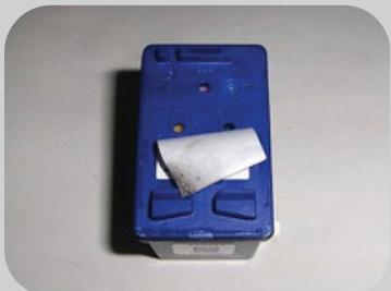
Despegar con cuidado la etiqueta superior del cartucho. Tratando de no rasgarla. No es necesario quitarla del todo con exponer los 3 orificios de entrada a los depósitos de tinta es suficiente.
